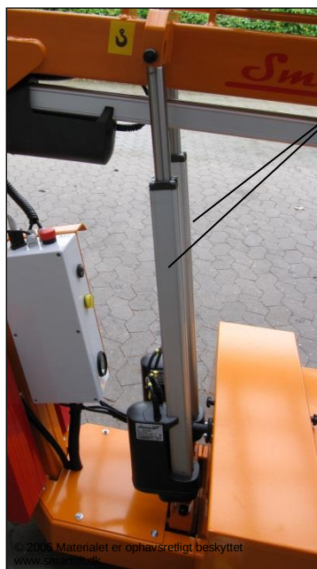
Aktuatorer for løft 2 stk. Linak LA 36
