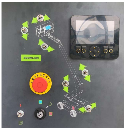
Figur 2-2 Kontrolpanel på jorden
