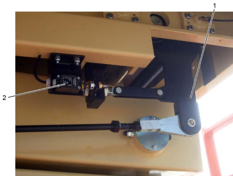
En af overbelastningssikrings løftestænger med afbryder
