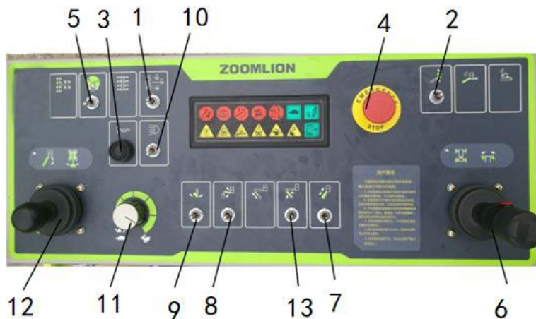
Figur 2-9 Platforms kontrolpanel (Kun det kontaktnummer, der svarer til det eksisterende funktion er identificeret.)
