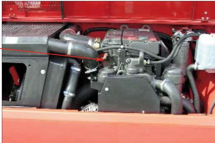
Un'altra vite di scarico si trova sul radiatore. Smontare il carter di protezione sotto il vano motore, sistemandovi sotto un recipiente di dimensioni adeguate alla quantità di liquido da raccogliere. Svitare il rubinetto F4/3 di scarico sul lato inferiore del radiatore per fare defluire il liquido di raffreddamento.
