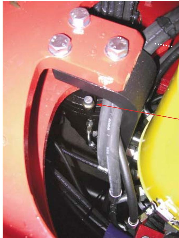
**E10 - Kontrol af oliestanden i svingmekanismens reduktionsgear**
