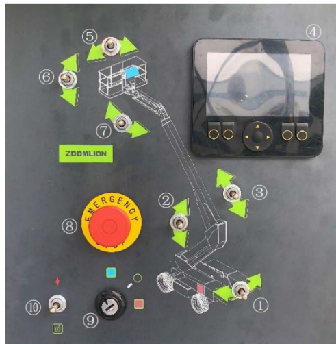
Figur 2-2 Kontrolpanel på jorden
