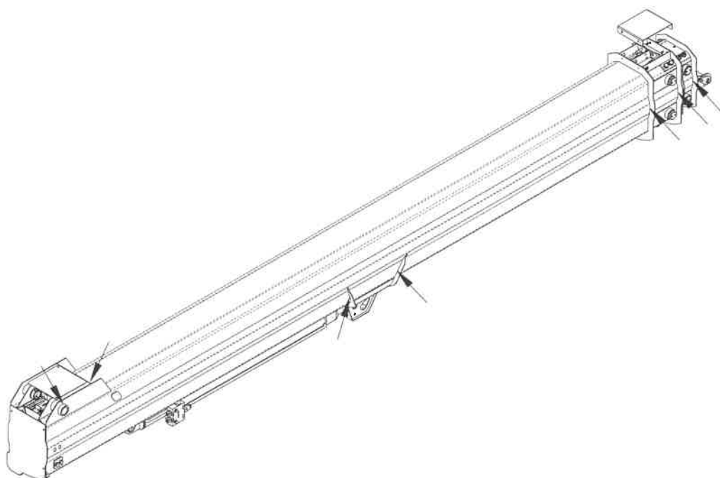
Fig. 6-1-12-B Øvre bomenhed Kritiske svejsninger 6-1-12
